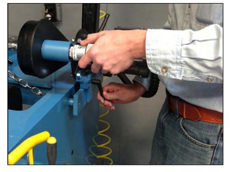
適合芝刈り機ソケットを選びなさい。 巻き 枠駆動機構モーターのシャフトにソ ケットを取付けなさい
