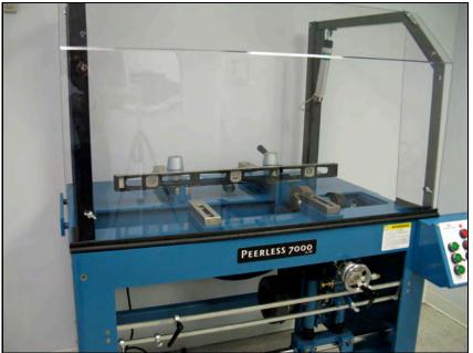
その最終的な場所での粉砕機では、レ ベル・パッドを調整するために大工のレ ベルを使用します。
