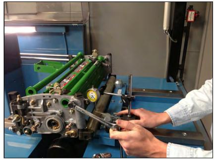
ローラーのもう一方の端の高いスポッ トを検索し、差の半分を削除するには、 リアローラーを調整します
