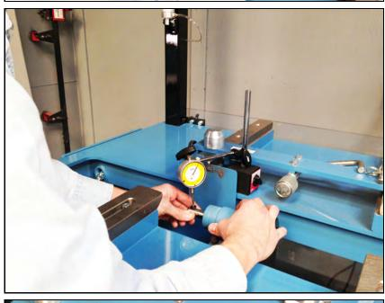
より小さくなるまで軸受ケーシングを 調節する。ねじボルトをきつく締めなさ い。軸受ケーシングは移動するべきでな い
