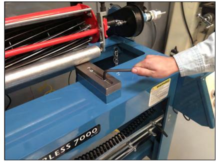
必要であれば、前部クロム芝刈り機サ ポートのソケットねじボルトをゆるめな さい。サポートを戻しなさい。ソケット ねじボルトをきつく締めなさ
