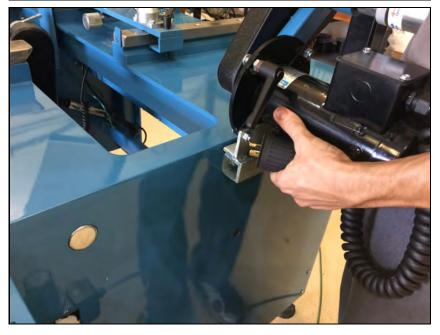
4.1 巻き枠に巻き枠駆動機構モーターを 接 続するこ
