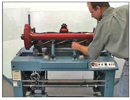
ベッドのナイフが調節しなければ、 芝刈り機が安定しているまでローラーを 調節する。それから巻き枠を調節しなさい
