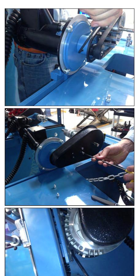
締めセットネジを締めま Re-tighten the set screw.
