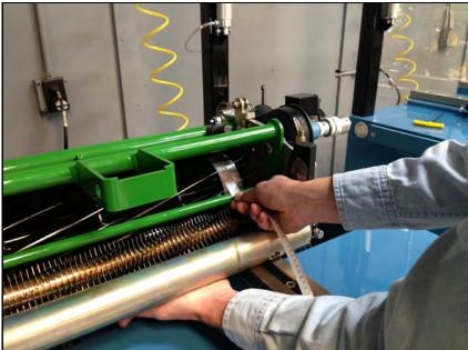
芝刈り機の右側に刃に口径測定テープ の磁石を置きなさい。磁石は刃の端を越 えて伸びるべきでない。芝刈り機を回 し、芝刈り機のまわりで口径測定テープ を包むように口径測定テープの張力を保 ちなさい。テープは直線で包むべきであ る。テープの端はテープの初めと並ぶべ きである
