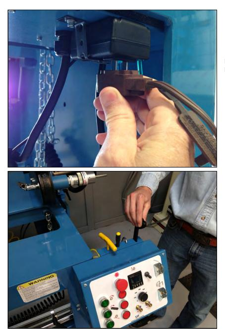
オプションのデジタル読み出しをお持 ちの場合は、背面パネルの下部にある変 圧器のプラグに延長コードを差し込みま す。110ボルトに接続します
