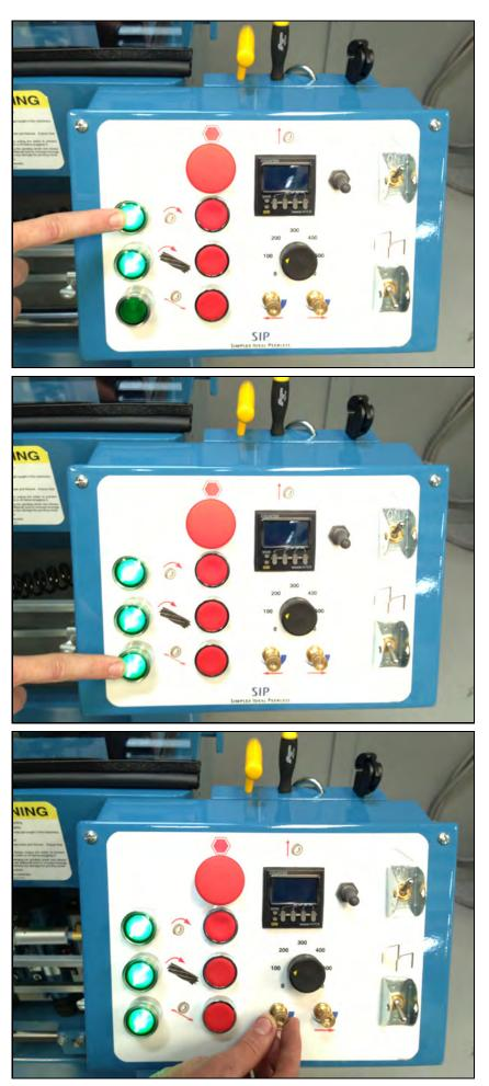
グラインダーモーターを開始しなさい Turn the grinding motor on.
