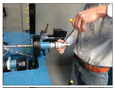
巻き枠駆動機構モーターシャフトの止 めねじをゆるめなさい。巻き枠にソケッ トを置いた。止めねじをきつく締めなさ い
