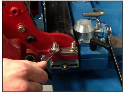
何の岩がなくなるまで、フレームをね じる、フレームとシールドのボルトを緩 めます。フレームとシールドボルトを増 し締め
