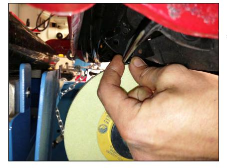
ブラケットのネジを締めてください Tighten the collar locking screw.
