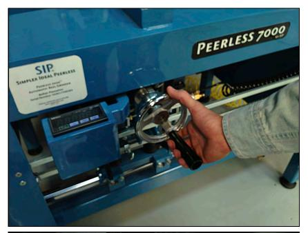
手動ハンドルを左回り回す。巻き枠 が小さいとき1か2回転を回す。巻き枠が 大きいとき3か4回転を回す。逃げ角は45 度を超過するべきでない
