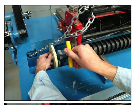
シャフトに小さい石を注意深く取付け なさい。停止にあるまで石を押しなさ い。シャフトに ハブをロックする止めね じをきつく 締めるのにアレンレンチを使 用しなさい。
