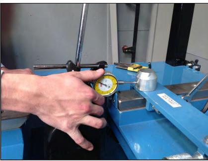
ダイヤルの表示器のプランジャを引っ 張りなさい。それを当らないポストの側 面に保障しなさい。右のポストの高いポ イントにグラインダーヘッドを移動しな さい。相違が010より多くなら、塀を調 節するべきである
