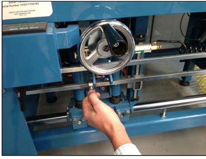
より低いキャリッジ停止のつまみね じをゆるめなさい。停止レバーに触れる まで停止を移動しなさい。つまみねじを きつく締めなさい。巻き枠の他の端にグ ラインダーを移動しなさい。その
