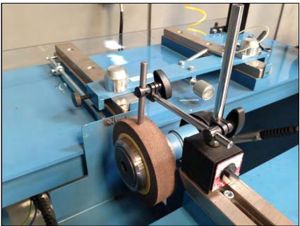
止めねじをゆるめなさい.変化が 001-.003 より小さくな?を回しな さい。止 めねじをきつく締めなさい。軸受 ケーシ ングは移動するべきでない。
