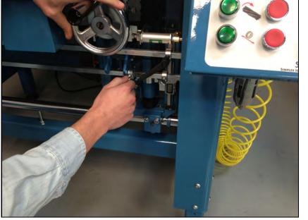
中間停止は円錐巻き枠のためである。 停止は砥石で研ぐことが停止するところ にである。停止は接触長さが増加すると き移動される
