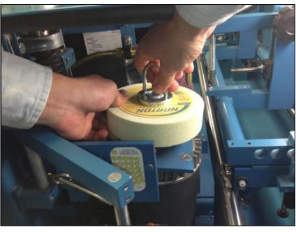
付属のuレンチで締め付けてください。砥石を傷つける可能性があるので、締めすぎないでください。研削砥石を取り付けた後最初の数回、研削モーターをオンまたはオフにするときは、特に注意してください。ナットが十分にタイトでない場合は、モーターをオフにすると、ナットと砥石が外れることがあります。
