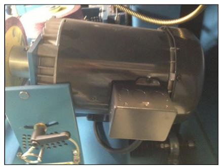
粉砕機には、定期的なメンテナンスを 必要としない、完全に密閉されたファン 冷却モータが装備されています。モー ターは真空または圧縮空気で定期的に清 掃する必要があります。
