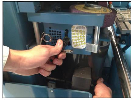
研削ヘッドのクランプを外します。 Unclamp the grinding head.
