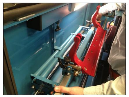
…それを左端で揺り動かしてから戻してください。これにより、左端が正しく 固定されます。
