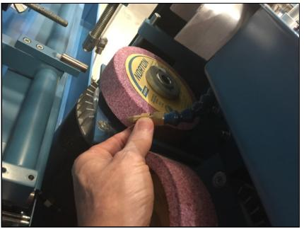
冷却液の流量を増減することができます。扉を開け、冷却液の瞬間的な切り替えを保持し、ノズルを回して冷却液を調節することができます。
