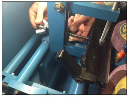
翼のナットを緩め、ベッドナイフが砥石に完全に接触するまでバックストップを調整し、翼のナットを締め直します。
