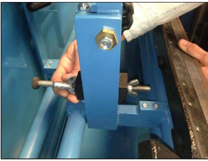
リアサポートを緩め、ベッドナイフの 背面の適切な高さに移動して締めます。
