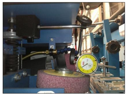
マグネットベースとダイヤルインジケータをフードの下側に締め付けます。 (これには、Peerless 7000リールグラインダーが付属しています)。
