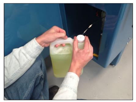
**5.3 クーラントの追加** 蓋を外し、ジャグを取る。 Remove the lid and remove the jug.
