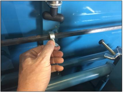
ストップは、固定ネジを緩め、ストッパを位置決めし、固定ネジを締めることによって設定されます。
