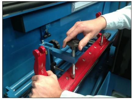
ベッドナイフのクランプを外します。 Unclamp the bed knife.
