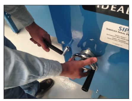
フロントフェイスモーターの電源を入れ、粉砕ヘッドをインフィードし、火花が出なくなるまでドレッサーを回転させます。 前面のモーターをオフにします。
