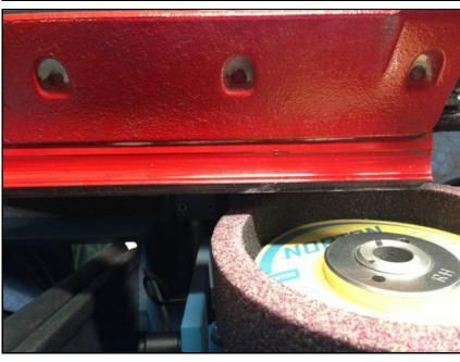
新しいブレードまたは使用済みブレードの前面にスクラッチが重い場合は、角度を調整して砥石を補正またはドレスアップする必要があります。
