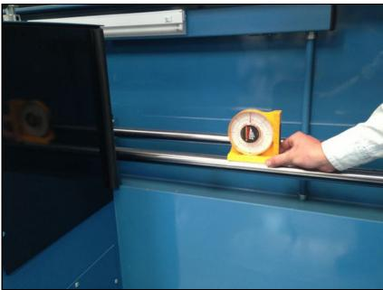
グラインダを最終位置に下ろします。 良質の大工レベルを使用してレベルのグ ラインダーをチェックしてください。
