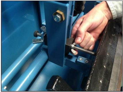
背中のサポートを再ロックします。 Relock the back support.
