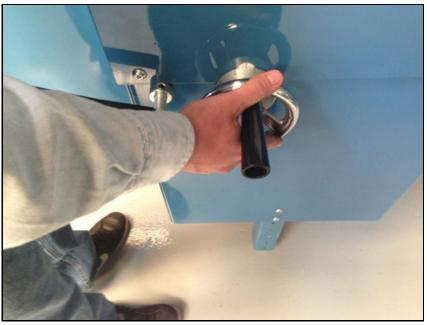
**4.2 前面石のドレッシング** フロントヘッドを前後に動かして... Move the front head in or out until ...
