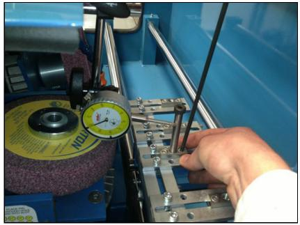
キャリッジをもう一方の端の位置合わせピンに移動させ、ピンの先端がゼロになるまで戻します。 ボルトを軽く締めてスライドナットを軽くたたくだけで、位置を微調整できます。
