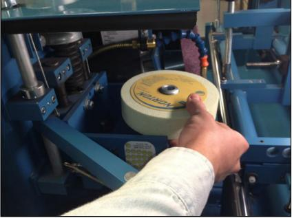
新しい砥石車をハブに置きます。 Place the new grinding wheel on the
