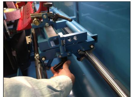
右パレットクランプをロックします。 Relock the right pallet clamp.
