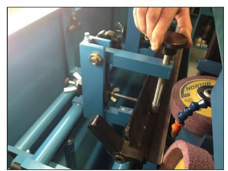
クランプを締め直します。 Retighten the clamp.
