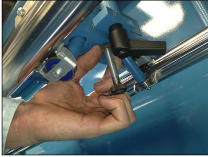
調整ネジをロックします。 Relock the adjusting screw.
