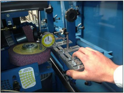
チップがアラインメントピンにちょう ど接触するようにインジケータを配置し ます。
