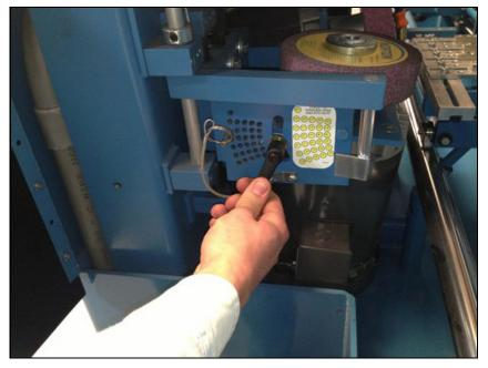
研削ヘッドをクランプする。 Reclamp the grinding head.
