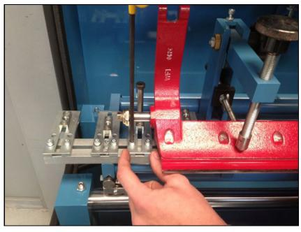
左右のスライドのボルトを緩め、ピン を両端のピボットボルトの後ろに置きま す。ボルトを締め直します。
