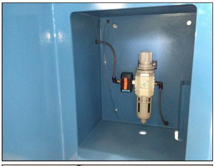
圧力計を60 psiに設定します。 Set the pressure gauge to 60 psi.
