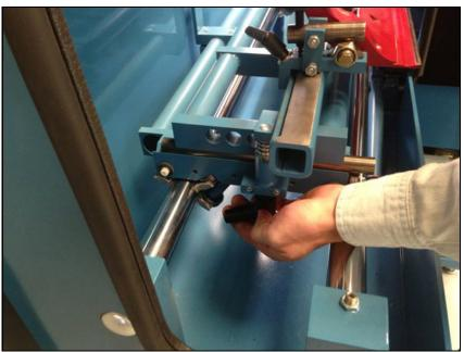
左パレットクランプをロックします。 Relock the left pallet clamp.
