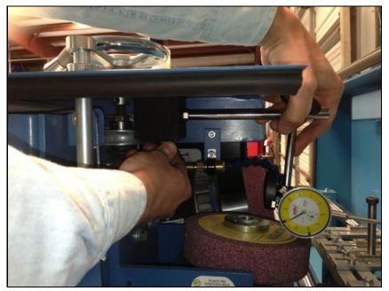
磁気ベースを取り外します。 ナットがセットされたら、移動させて はいけません。
