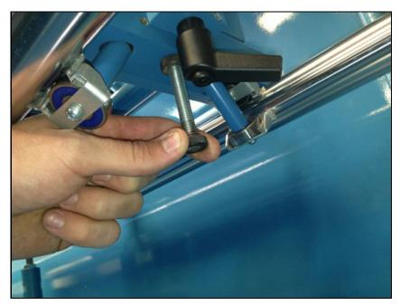
垂直調整ネジを回して、上部ができる だけ均一になるようにします。
