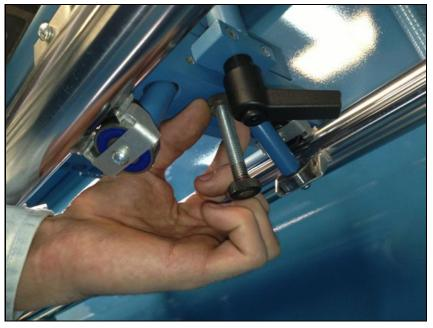
垂直調整ねじのロックを解除します。 Unlock the vertical adjusting screw.
