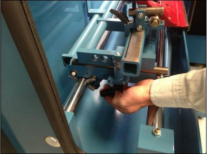
クランプをパレットの上に回します。 パレットの左端を締めます。
