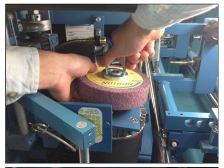
付属のuレンチを使用して、砥石を持ち、ホイールナットを緩めます。 左のグラインダーは時計回りにゆるんでいます。 右の粉砕機は反時計回りに緩んでいます。
