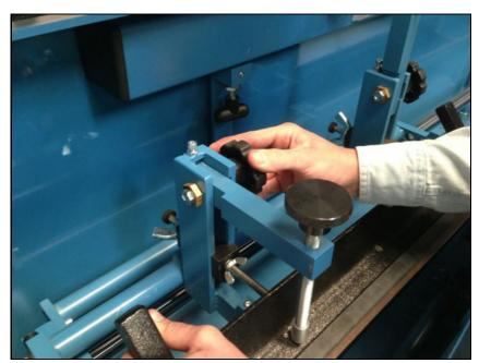
アームをスロットに固定します。 クランプネジがベッドナイフにきつくないことを確認します。
