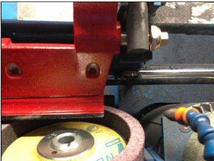
ベッドナイフ (内側の端) に接触する 研削ホイールの部分は、ベッドナイフの 端を過ぎている。
