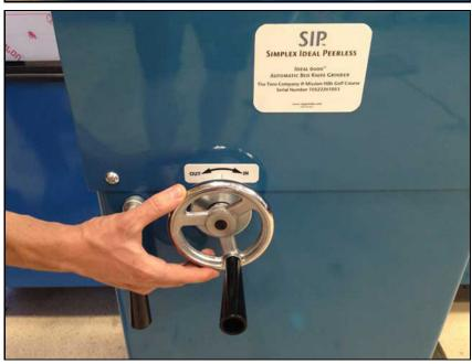
インフィード研削砥石まで.. Infeed the grinding wheel until..
