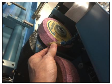
ノズルを回転させることで、クーラントの流れを調整することができます。
