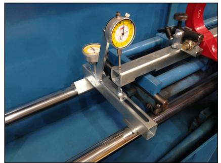
パレットの左端にパレットゲージを セットします。 両方のダイヤルインジ ケータがゼロになるようにゲージを調整 します。
