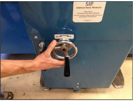
フロントフェイスの右砥石をバックオフします。 右の粉砕モーターをオフにします。
