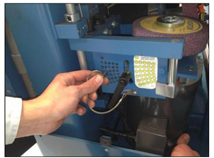
位置決めピンを取り外してください。 Remove the positioning pin.
